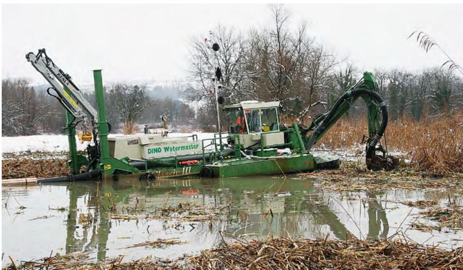
Saugbaggerung der Schlammsedimente im Wydhauweiher, Rottenschwil, Dez. 2011 – eines der grossen Biotopsanierungsprojekte unter der Leitung von Gottfried Hallwyler.
